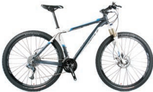
TREK X-CALIBER € 1499,- gewicht 12,2 kg. • frame aluminium 6061 T6 • voorvering Rock Shox Reba RL, remote lockout, 100 mm • derailleurs Shimano Deore / SRAM X-7 • remmen Avid Juicy 3 185/160 • wielen Bontrager SSR-velgen / Shimano M525-naven • banden Bontrager 29-2, 2,10" • www.trekbikes.com
