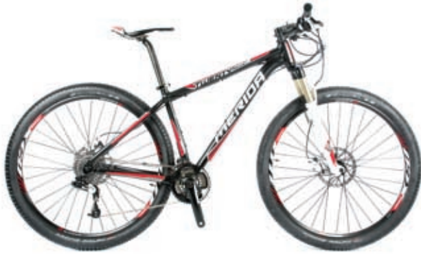
MERIDA TWENTY-NINE LITE 1800-D € 1799,- gewicht 11,8 kg. • frame aluminium lite-D-single • voorvering Rock Shox Recon Gold TK solo air, poploc 100 mm • derailleurs SRAM X-9 • remmen Avid Elixir 5 185/160 • wielen Alex Rims-velgen / SRAM MTH506-naven • banden Schwalbe Racing Ralph 2,25" • www.merida.nl
