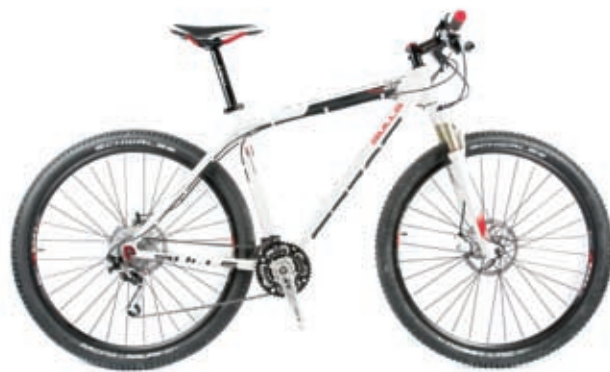
BULLS COPPERHEAD 29 PLUS € 1699,- gewicht 11,7 kg • frame aluminium 7005 • voorvering Rock Shox Reba RLC 29, poploc remote lockout, 80 mm • derailleurs Shimano XT • remmen Formula RX 180/180 • wielen Alex XC-24, Shimano Deore XT • banden Schwalbe Nobby Nic 2,25" voor / Schwalbe Racing Ralph 2,25" achter • www.bulls.de
