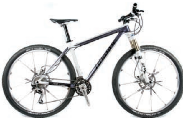
HAIBIKE BIG CURVE RC € 2499,- gewicht 11,3 kg • frame aluminium 7005 triple butted, 12 mm steekas • voorvering Fox F100 RL100 mm, 15 mm steekas • derailleurs Shimano Deore XT • remmen Avid Elixir 3 185/185 • wielset Crank Brothers Cobalt 15 mm as voor / 12 mm as achter • banden Schwalbe Racing Ralph 2,25" • www.haibike.de
