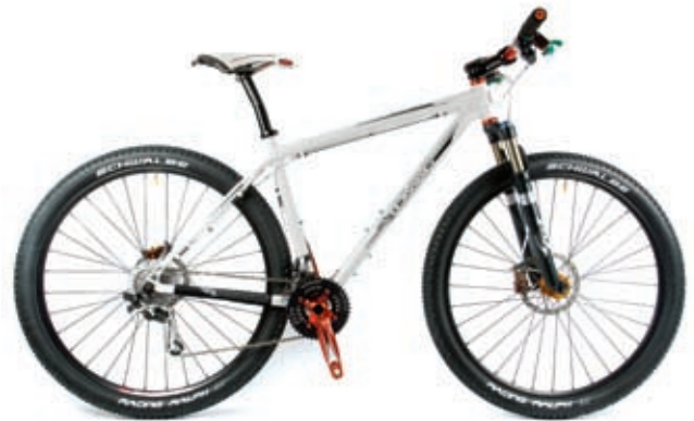
TOMAC FLINT € 2500,- gewicht 10,6 kg. • frame aluminium AN-6, excentrisch bracket • voorvering Fox F29RL 80 mm • derailleurs Shimano Deore XT • remmen Trickstuff The Cleg 180/160 • wielen FRMXMD388 TR-velgen / FRM Urano-naven • banden Schwalbe Racing Ralph 2,40" • www.tomac.com
